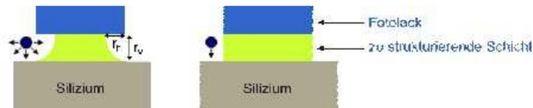
**Figure 63:** Isotroper (links) und anisotroper (rechts) Ätzzvorgang
