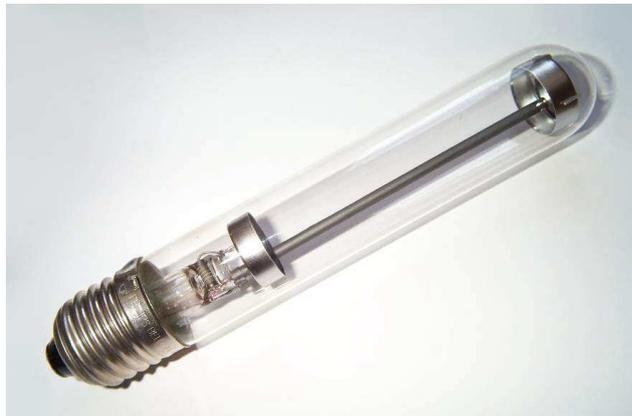
**Figure 46:** Niederdrucklampe von Philips. Die Lampe wird für die UV-Entkeimung angeboten und nutzt das Linienspektrum des Quecksilbers bei 254 nm. Sie hat deshalb ebenfalls keine Fluoreszenzschicht, was die freie Betrachtung der beiden Ringelektroden ermöglicht, die zur Optimierung der Zünd- und Betriebsbedingungen mit Widerständen aus graphitbeschichteten Quarzrohren mit der Eingangsspannung gekoppelt sind.
